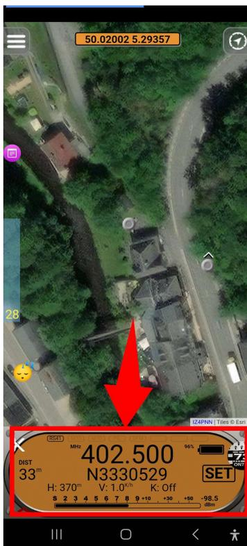
Sur la partie inférieure on peut voir la fréquence de la sonde, le type, la distance par rapport au smartphone. En cliquant sur set, on peut ajuster la fréquence et le type de sonde (dans les écrans suivants) et sauve le setting vers le TTGO. Au-dessus on trouve les coordonnées de la sonde.
