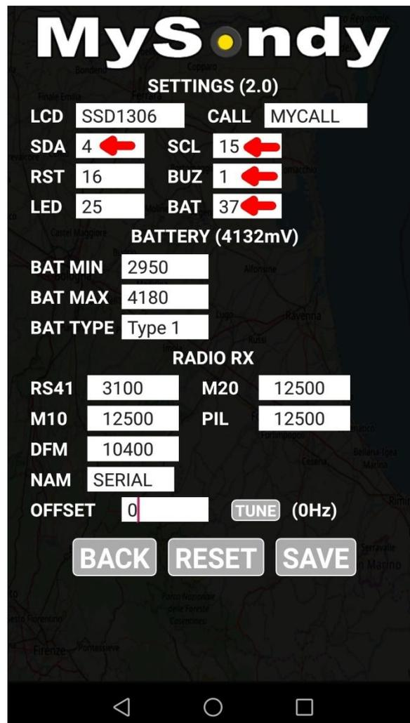
Per una corretta lettura della tensione della batteria, è necessario aggiungere un partitore resistivo composto da una resistenza da 100K tra il pin 37 e GND e una resistenza da 180K tra il pin 37 e il terminale positivo della batteria.
